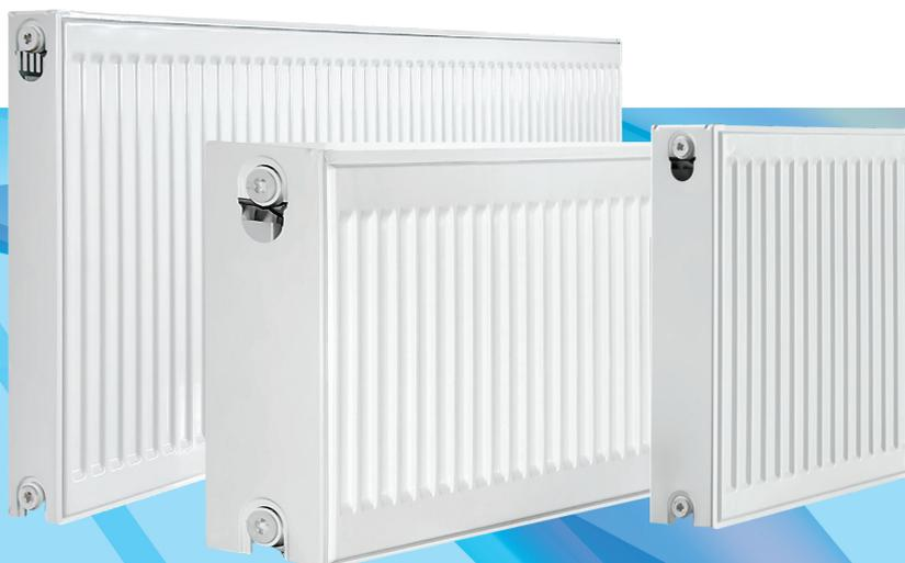
Стальные панельные радиаторы Alecord отвечают всем требованиям, предъявляемым к отопительным приборам в соответствии ГОСТом 313111-2005. Радиаторы Alecord производятся из высококачественной холоднокатаной стали с толщиной 1,2 мм. Чистый белый цвет RAL 9016 достигается использованием электрофореза и электронного напыления полиэпоксидной порошковой эмали.
