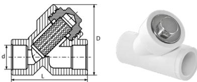
Предназначен для фильтрации, потока жидкости и газа. Фильтрующий элемент – сетка из нержавеющей стали. Рекомендуем для систем ГВС и ХВС.
