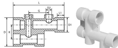
Предназначен для монтажа пересекающихся трубопроводов в инженерных системах водоснабжения и отопления. Позволяет расположить все трубы в одной плоскости.
