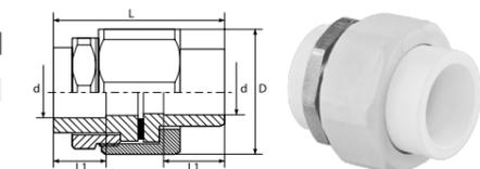
Используется для получения разъемного соединения между полипропиленовыми трубами. На резьбовом штуцере имеется шестигранник из пластика, за который муфта удерживается при натяжке.
