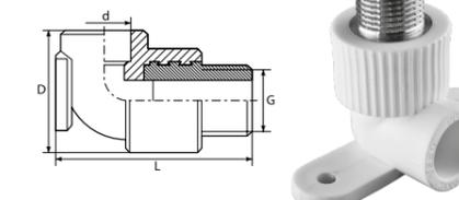
**УГОЛЬНИК С НАКИДНОЙ ГАЙКОЙ (МЕТАЛ. ШТУЦЕР)**
