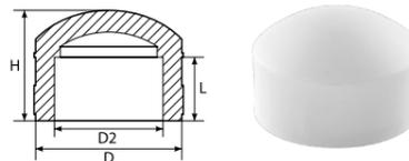
Предназначена для заглушения конца трубы при помощи сварки.
