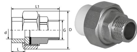
Используется для получения разъемного соединения между металлической и полипропиленовой трубами. На резьбовом штуцере имеется шестигранник, за который муфта удерживается при натяжке.
