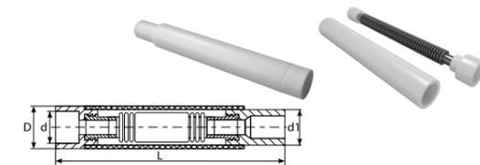
Устройство предназначено для компенсации тепловых расширений полипропиленовых труб (армированных и неармированных) в системах отопления и водоснабжения. Изделие запатентовано. Патент №149569.
