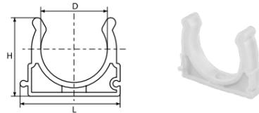
Выполняет функцию скользящей опоры. Позволяет трубе перемещаться в осевом направлении при исключении бокового перемещения.
