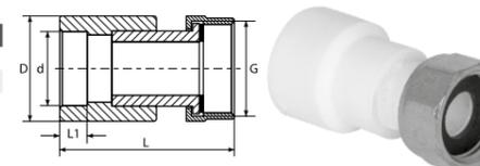
Разъемное соединение между полипропиленовой трубой и металлической трубой или фитингом с наружной трубной резьбой (пластиковый штуцер).
