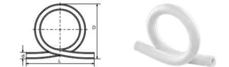
Применяется с целью компенсации теплового расширения полипропиленовых труб.
