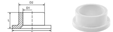
Для создания фланцевого соединения – при переходе на другую трубу или задвижку. Для соединения требуется специальный стальной расточной фланец. Труба сваривается внутри бурта.
