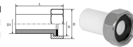
Разъемное соединение между PP-R фитингом и металлической трубой или фитингом с наружной трубной резьбой (пластиковый штуцер).
