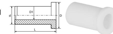
Борты используются для монтажа счетчика воды СВ15 (или любого другого с выходом резьбы на 3/4"). Он позволяет сразу, не используя комбинированных деталей, соединить PP-R фитинг со счетчиком.
