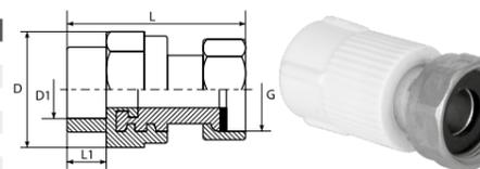
Разъемное соединение между полипропиленовой трубой и металлической трубой или фитингом с наружной трубной резьбой (латунный штуцер).
