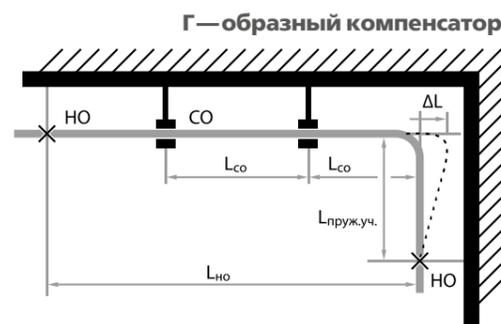
В целях устранения разночтений предлагается производить отсчет пружинящей длины от оси горизонтального участка трубопровода:
