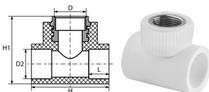
Для создания резьбового бокового отвода трубопровода.
