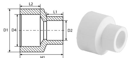
Предназначена для соединения труб и фитингов разного диаметра.
