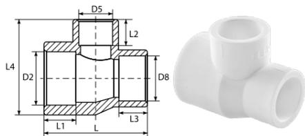
Тройник под сварку для соединения труб и фитингов разных диаметров.
