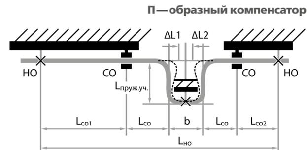
При решении тепловой компенсации участка трубопровода с использованием трубного П-образного компенсатора можно применить два приема его расположения между неподвижными опорами:
