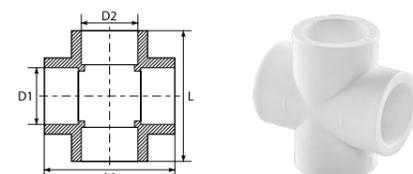
Для соединения четырех труб одного диаметра в одной плоскости.
