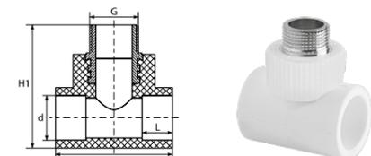
Для создания резьбового бокового отвода трубопровода.
