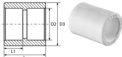
Предназначена для соединения между собой труб одного диаметра.
