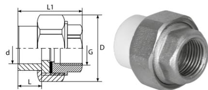
Используется для получения разъемного соединения между металлической и полипропиленовой трубами. На резьбовом штуцере имеется шестигранник, за который муфта удерживается при натяжке.
